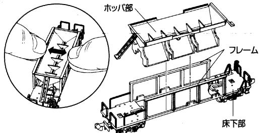
3. ホッパ部を外したら、イラストを参考に各パーツを取り付け、ホッパ部を床下部に戻します。その際、床下部の矢印とホッパ部裏側にある矢印の方向を合わせて組み立てます。
